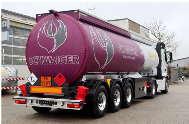
Alle neuen Sattelanhänger von Rohr sind schon heute mit dem ab 1. September dieses Jahres geforderten hinteren Unterfahrschutz ausgerüstet.
