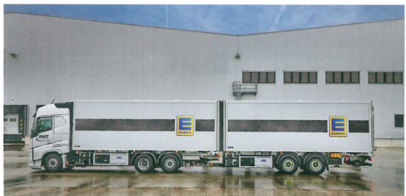
Rohrs Tunnelzug in Durchladestellung
